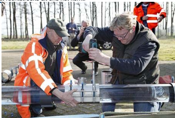
Voordat we met de eerste test kunnen beginnen, plaatsen we vier aanboorzadels op de transparante leiding. Daarmee volgen we de
