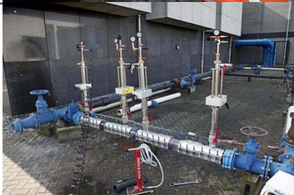
De gehele proefopstelling voor het testen van de gasblazen.
