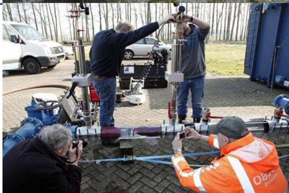
Tijdens het opblazen van de tweede blaas blijkt de eerste blaas goed op zijn plek te blijven zitten. Ook blijft de druk tussen de blazen constant. Dat betekent dat de blazen goed werken.
