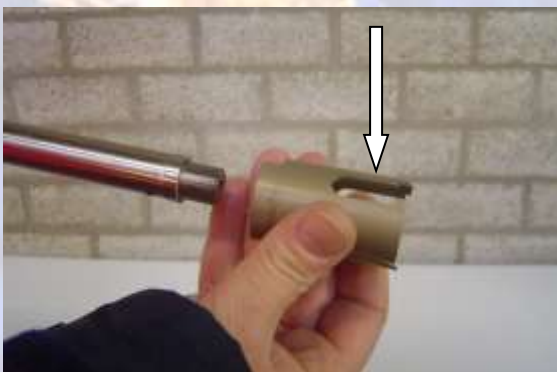
26. En dit is de frees die u gebruikt voor AC. Op het kokertje van deze frees staat het leidingmateriaal geprint.
