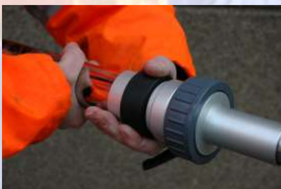
15. Draai de zwarte wartel geheel op tot deze niet verder kan. Doe dit bij voorkeur in een verticale positie.
