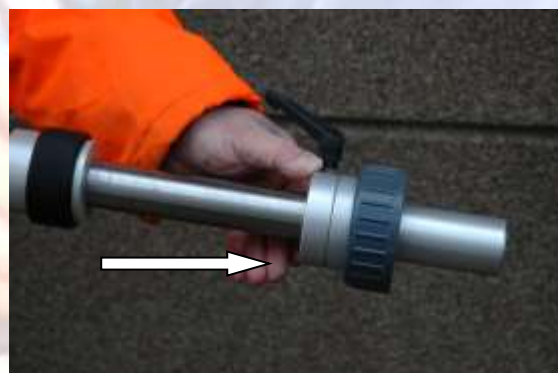
17. Trek de manometerstang en MDS-blaas terug, borg de manometerstang en schuif de wartel van de zakpijp naar beneden.
