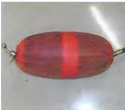
Fig. 1. Deze MDA-blaas van KLEISS (grootte 0160-215) kan worden toegepast bij een afsluitdruk van maximaal 4 bar.
