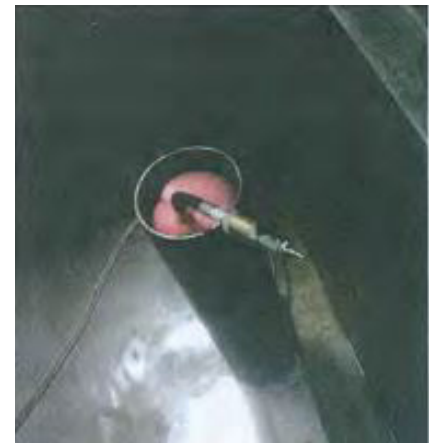
Fig. 12. Testopstelling bij CRIGEN voor het vaststellen van de bestendigheid van een MDA-blaas in een stalen buis. Het testobject bevindt zich in een klimaatkamer.
