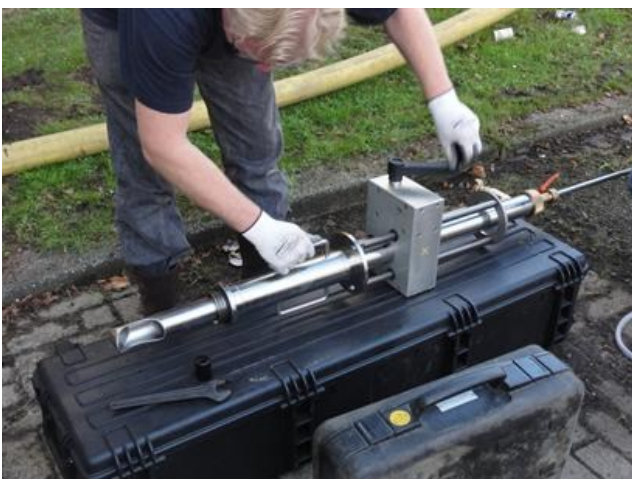
De gasblaas draaien we hier omhoog in het opzetstuk.
