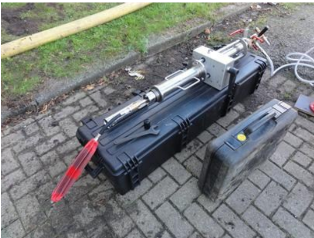
Opzetstuk met gasblaas, deze ontsmetten we voor hij op het zadel gaat.
